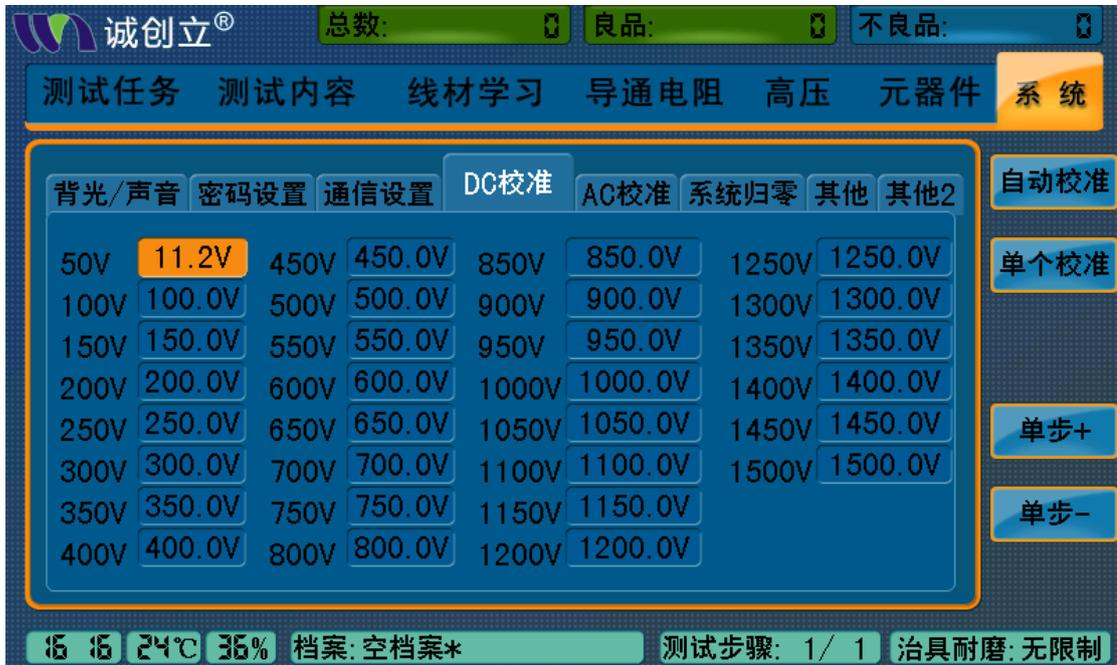
按【系统】键进入系统界面→按方向键选择 {DC 校准项} →按【F1】键【自动校准】电压，使标准值与实际值尽量一致
